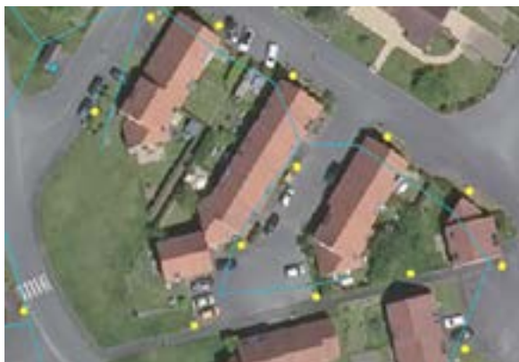
Réseau d'éclairage public non géoréférencé.
