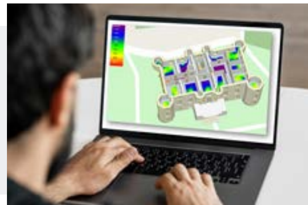
Exemple de modélisation de la mairie de Bagnoles de l'Orne Normandie analyse du confort thermique du bâtiment.
